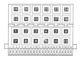
13 - Relais pour pompe hydraulique d'ABS (78)
