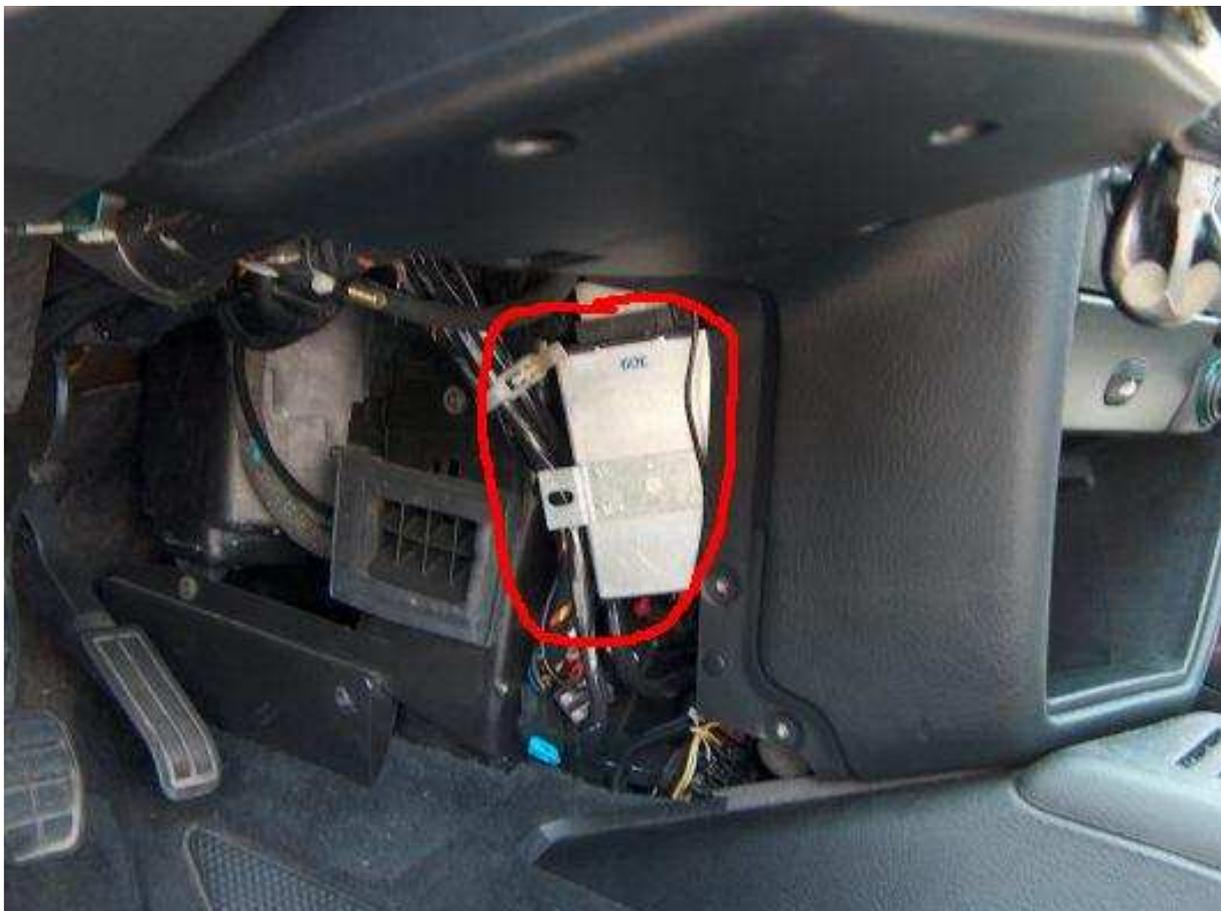
Je démonte la pédale d'accélérateur pour ajouter l'axe (3) sur lequel la tige (4) venant de la valve va se fixer. Je profite, tant qu'il n'y a pas la pédale, pour installer la valve (2), reliée à la pompe à dépression par le tuyau (1) venant du compartiment moteur.
