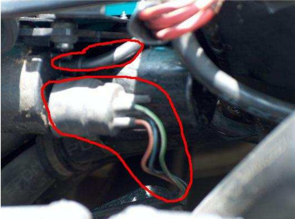
On peut voir sur la photo le faisceau électrique qui vient du boîtier électronique, et juste au dessus le tuyau qui va permettre la dépression dans le circuit et commander la pédale d'accélérateur.
