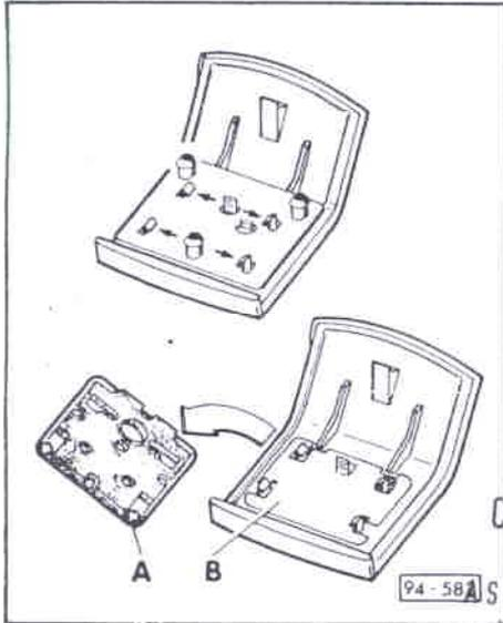
◀ **Fig 2 Touche de commande du klaxon: dépose**
