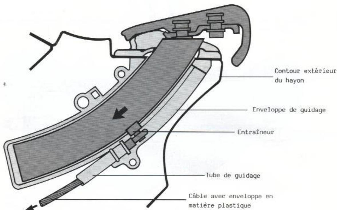
Les enveloppes de guidage des supports mobiles sont vissées sur le contour extérieur du hayon arrière par les vis de fixation des plaques d'étanchéité.
