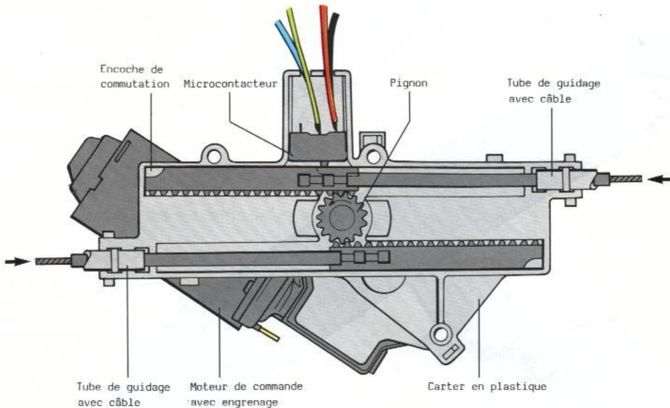
Le moteur de commande entraîne le pignon par le biais d'un engrenage, ce qui provoque le déplacement en sens opposé des crémaillères, qui, suivant le sens de rotation du moteur, sortent ou rentrent. Les tubes de guidage sont clipsés dans le carter en plastique et les câbles accrochés aux crémaillères. Les deux microcontacteurs sont placés l'un au-dessus de l'autre. Un thermocontacteur, installé dans le moteur de commande, met ce dernier hors circuit en cas de surchauffe.
