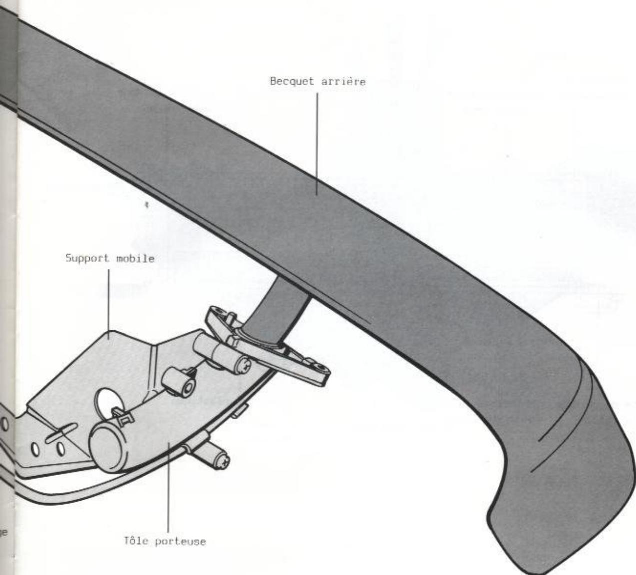
Si la sortie du becquet arrière n'est pas déclenchée par la commande électrique, elle peut être aussi provoquée mécaniquement par la manette. Il faut alors sortir la manette de sa position de crantage en la tirant vers l'avant.
